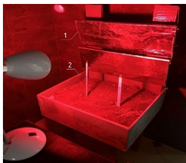
Рис. 3. Экспериментальные замеры температур грунта с помощью опытного образца установки:
