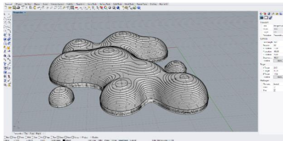
Рис. 2. Модель конструкции крыши стадиона в виде ракушки
