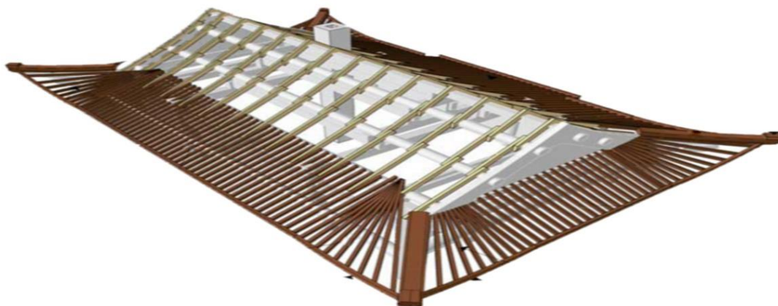
Рис. 2. Стропильная система крыши
